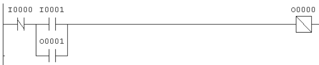
Figura 4.1 – Programa em Ladder para partida direta de um motor
